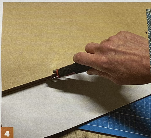
4 Die Tapete für die Rückwand des Schrankes und für die Innenseiten der Türen mit einem Cuttermesser auf Maß schneiden .
