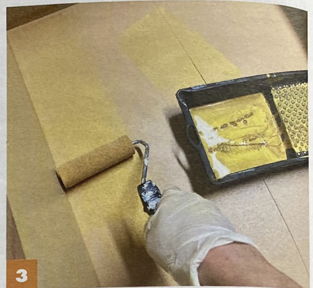
3 Innenrückwand und Seitenwände des Schrankes ebenfalls in Gold lackieren. Die Innenseiten der Türen auslassen.
