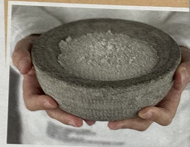
4 Milk Paint anmischen (s. Kasten), 10 Minuten ruhen lassen, erneut verrühren. Auch während des Streichens immer wieder ...
