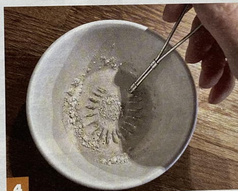
4 Milk Paint anmischen (s. Kasten), 10 Minuten ruhen lassen, erneut verrühren. Auch während des Streichens immer wieder ...
