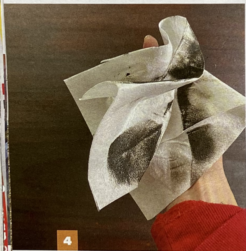
4 Nach zehn Minuten den Überschuss abnehmen. Ist die Beize getrocknet, die Fläche ein zweites Mal beizen.
